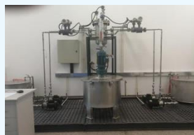
撞击流技术制备超细粉体工业示范化装置
